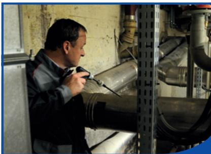
La version expert intègre en standard la mesure de NO et NO<sub>2</sub>. L'analyseur est équipé d'un tuyau en teflon et d'un pot de condensation refroidi.
