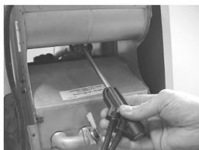
L'ECOM CL ne doit plus être déplacé après le calibrage du capteur de tirage
