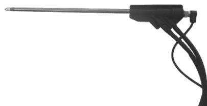
Sonde permettant la mesure des fumées, de la température des fumées et du tirage
